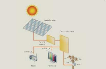
Sistema di funzionamento "connesso in rete"
