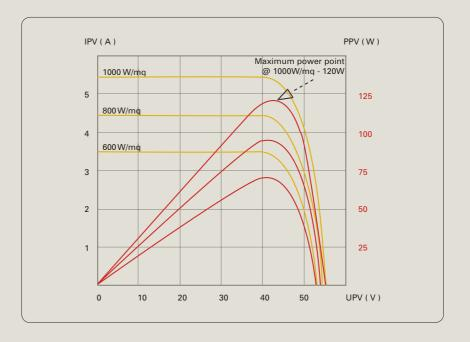
Graficamente, il punto di massima potenza, corrisponde al punto di tangenza tra la caratteristica del generatore fotovoltaico per un certo valore della radiazione solare e l'iperbole di equazione VxI= costante corrispondente. Come abbiamo visto, il punto tica. di tangenza varia istantaneamente in
